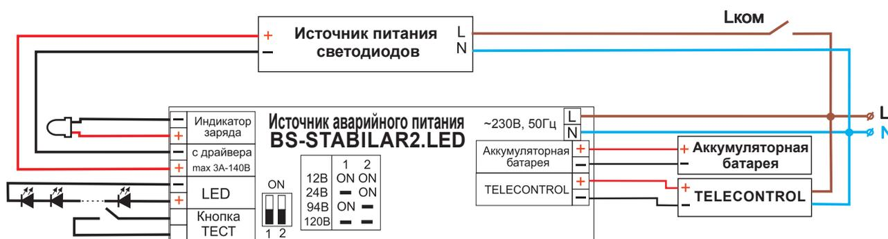
Принцип работы BS-STABILAR2-LED в постоянных в постоянных аварийных светильниках:
