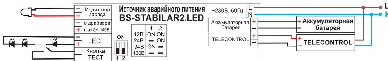
Принцип работы BS-STABILAR2-LED в непостоянных аварийных светильниках:
