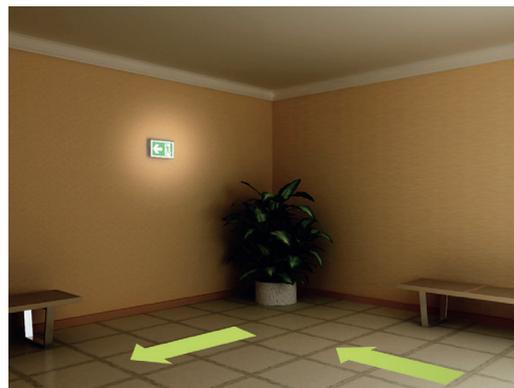
Дистанция между двумя соседними световыми указателями по пути эвакуации не должна превышать значение расстояния распознавания используемых знаков. При этом, согласно СП 256.1325800.2016, рекомендуется ограничивать расстояние между ближайшими световыми указателями до 25 м. [7, пп. 5.1.5; 9, пп. 5.4]
