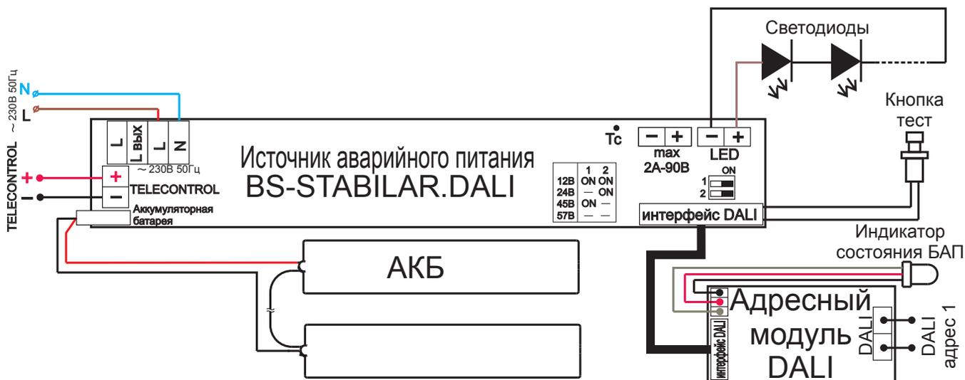
Принцип работы BS-STABILAR-81/3-B1/B2/B3/B4-DALI в непостоянных аварийных светильниках:
