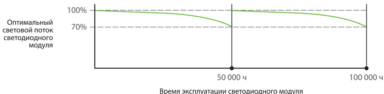
Переключение на вторую цепь светодиодов рекомендуется делать при плановой замене аккумуляторной батареи, обычно через 4–5 лет эксплуатации, т.е. примерно 50 000 часов. Световые приборы Технического решения № 1 имеют срок службы 10 лет (87 600 часов), таким образом, световые приборы укомплектованы светодиодными источниками света на весь срок эксплуатации.
