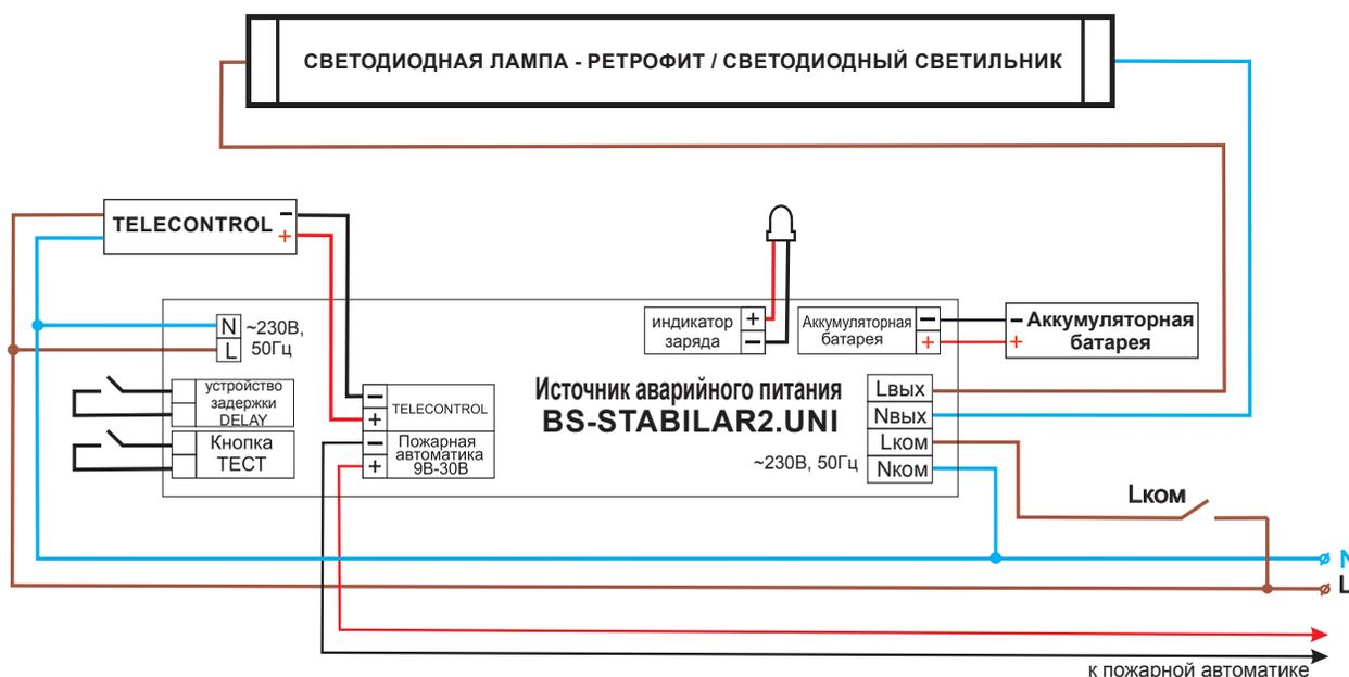
Пример схемы подключения к светильникам с люминесцентными лампами с электронными ПРА.
