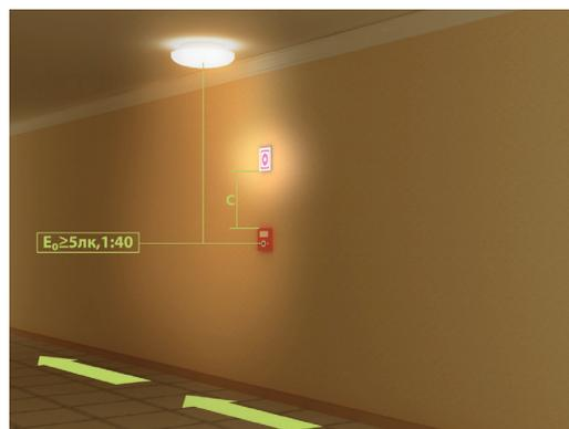
Питание световых указателей в нормальном режиме должно производиться от источника, независимого от источника питания рабочего освещения, а в аварийном режиме переключаться на питание от третьего независимого источника, например встроенную в прибор аккумуляторную батарею. Продолжительность работы световых указателей должна быть не менее 1 часа и соответствовать расчетному времени эвакуации. [3, пп. 7.6.10]
